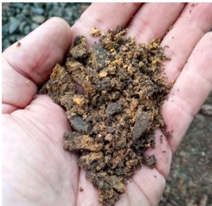
Obr. 6 Charakter rozloženého až silně zvětralého skalního podkladu (středně až hrubě zrnité křemité pískovce)
