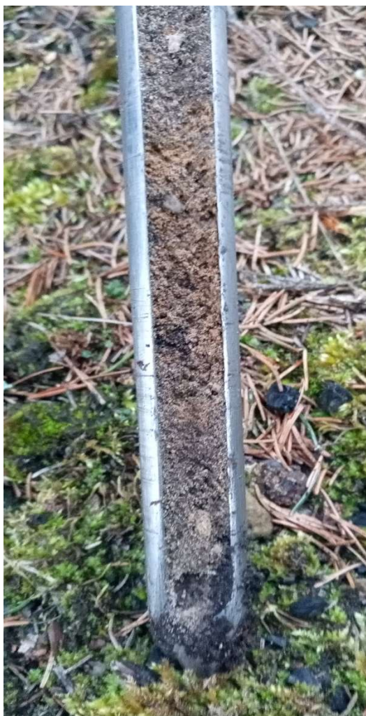
Obr. 5 Charakter svahových sedimentů (středně až hrubě zrnitých křemitých písků)
